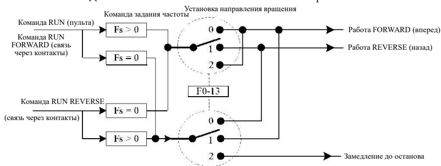
Рис. 4-22. Иллюстрация выбора направления вращения двигателя
