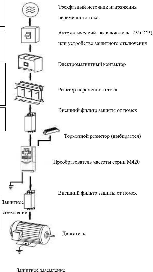
Рис. 1. Иллюстрация подключения периферийных устройств
