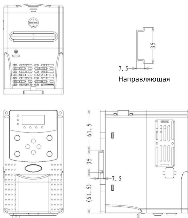
Рисунок 2-5. Габариты преобразователя и размеры монтажных отверстий
